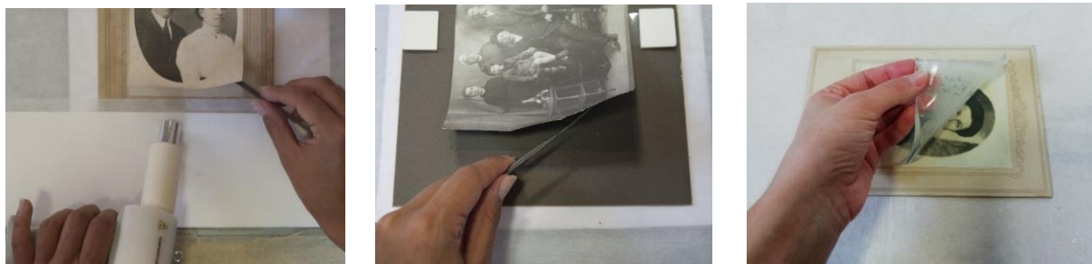
Figura 3, 4 e 5. Distacco con vaporizzatore ad ultrasuoni, distacco meccanico a secco, distacco per imbibizione dal recto con gel di gellano.
